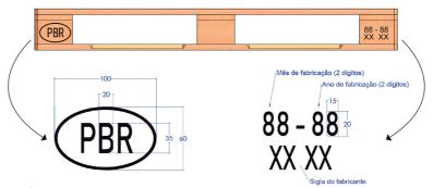
✓ Paletes falsificados podem ser facilmente identificados pela marcação em lados errados, ausência da sigla do fabricante, medidas ou grafias diferentes das recomendadas ou falta de dados relativos ao mês do ano de fabricação.
